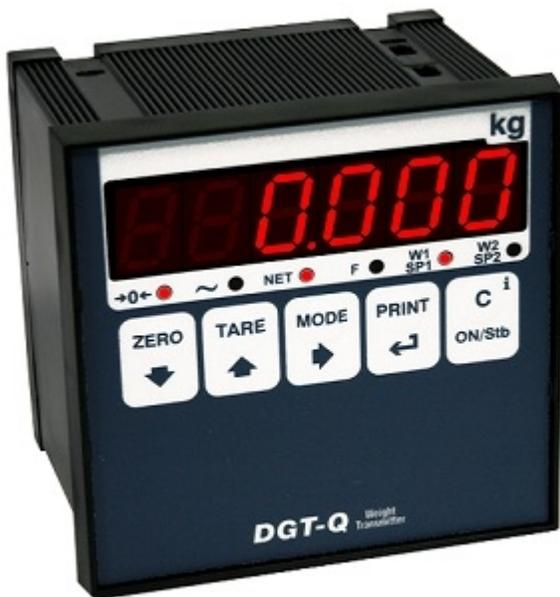
机柜式安装多功能重量变送器, 可作为独立的4通道使用, 或经接线盒连接的4个非独立通道使用, 而且可诊断每个连接的传感器状况, 诸多接口使其适用于任何自动化系统。还提供经CE-M认证型号(OIML R-76 / EN 45501)。
