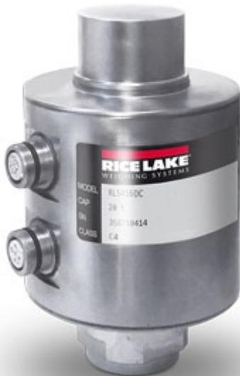
Celle di carico digitali a compressione per pese a ponte omologate CE-M, serbatoi, silos, ecc. Studiate per collegamento diretto all'indicatore di peso, **SENZA SCATOLA DI GIUNZIONE**. Esecuzione in acciaio INOX, con grado di protezione IP68, 4000 divisioni.
