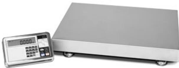
Bilancia da pavimento ad alta precisione per zone classificate a rischio di esplosione. Grado di protezione II 1G Ex ia II B T4 Ga per gas. Omologabile CE-M (OIML R-76 / EN 45501).
