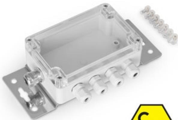
Scatola di giunzione IP67 a 4 ingressi, per unione di 2, 3 o 4 celle di carico. Marcatura: ATEX II 2G Ex ib IIC T6 Gb per gas. ATEX II 2D Ex tb IIIC T115°C Db IP65 per polveri.
