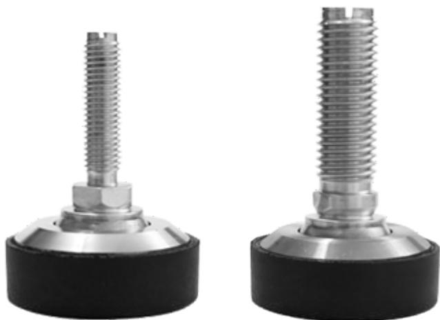
Piedini snodati in acciaio INOX studiati per ottenere le migliori prestazioni di pesatura, particolarmente indicati per la creazione di piattaforme a 4 celle di carico. Estremamente compatti e semplici da installare, minimizzano l'altezza della piattaforma e garantiscono un disaccoppiamento perfetto delle forze laterali in fase di pesatura.
