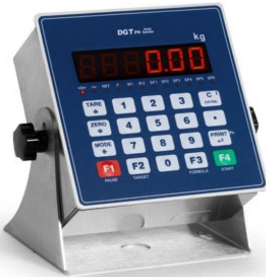
多功能重量变送器/称重显示器，可安装在机柜中。该称重控制器适用于工业称量或配料系统中，且易于集成在任何自动化系统中。配有4输入和6输出。通过数字键盘可快速输入限值及皮重。还提供经CE-M认证型号(OIML R-76 / EN 45501)。
